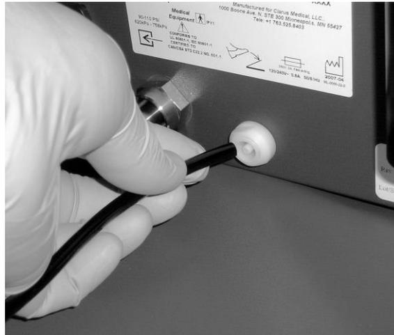
**Figura 7: Ligação do interruptor de pedal**
