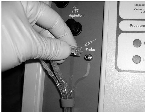
**Figura 13: Ligação do tubo da sonda**
