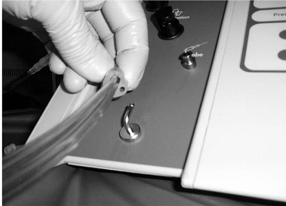
**Figura 12: Instalação do tubo da sonda no gancho retentor**
